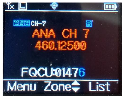
Mit dem FQCU Wert lässt sich die Referenzfrequenz und damit die Sollfrequenz verstellen. Ursprungswert aufschreiben und mit Kanalwahlschalter den FQCU Wert verstellen. Mit dem Ausschalten wird der neue Wert im Funkgerät gespeichert. Nach dem Einschalten kann das Funkgerät normal genutzt werden. Neue Sollfrequenz (sinnvollerweise z.B. 435,000 MHz kontrollieren. Im hier angewendeten Fall entsprechen 100 Punkte Änderung des FQCU Werts ca. 300 Hz.
